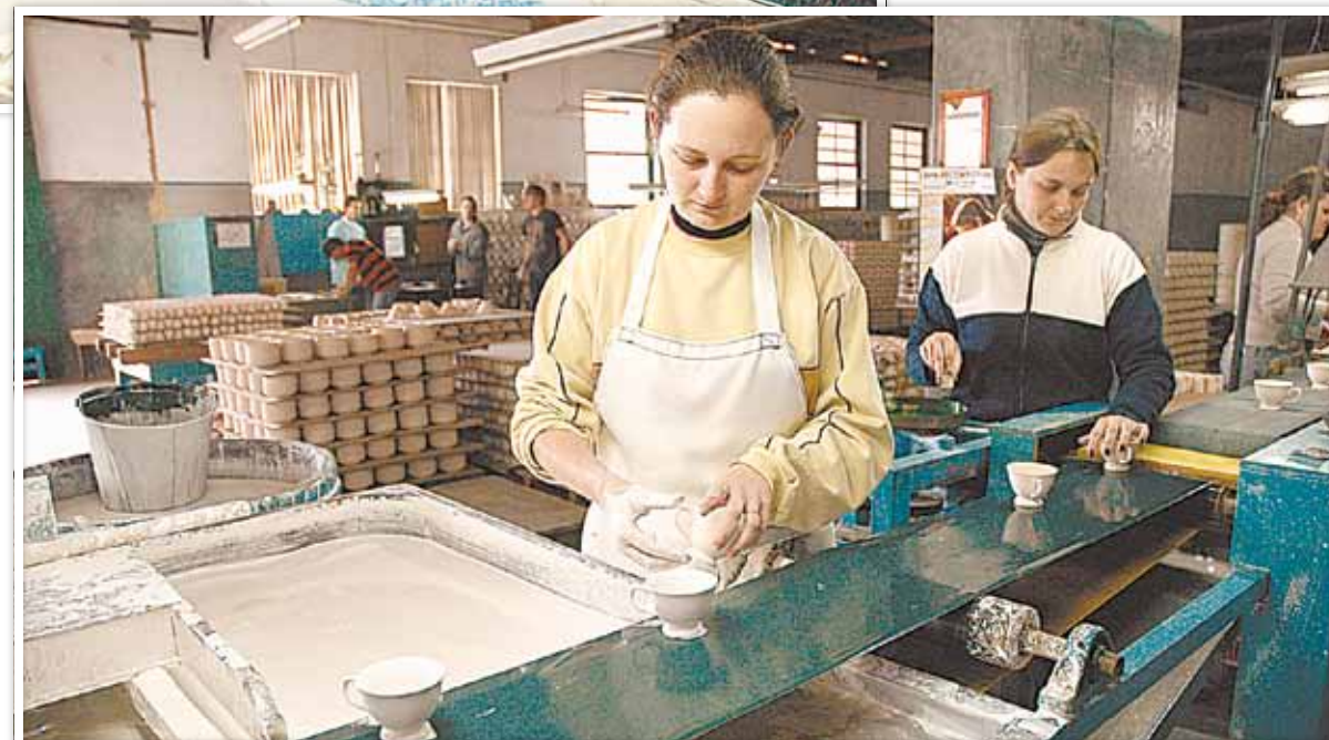
Depois da primeira queima, xícaras são imersas no verniz, formando uma película que garante resistência às peças
