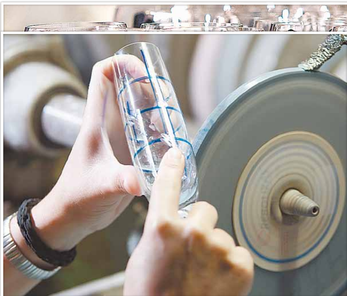
Depois de riscadas com traços à tinta, peças são levadas à máquina para garantir desgaste e evidenciar desenho
